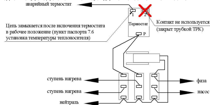
Рисунок 6 – подключение термостата
